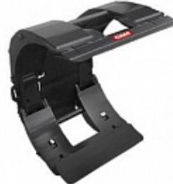
Раздельная длинная лапа позволяет одновременно работать с двумя бумажными рулонами разного диаметра. Подвижная короткая лапа позволяет обрабатывать рулоны в широком диапазоне диаметров. Противоударный ограничительный клапан на каждом цилиндре. Более тонкий профиль лапы и передача максимального захватного усилия на контактные накладки. Новые геометрические пропорции компонентов захвата и улучшенный обзор сквозь лапы. Система вращения на 360°.
